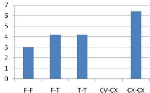
FIGURE 10 . PERCENTAGE ELONGATION FW JOINTS ,(AT 775 RPM)
