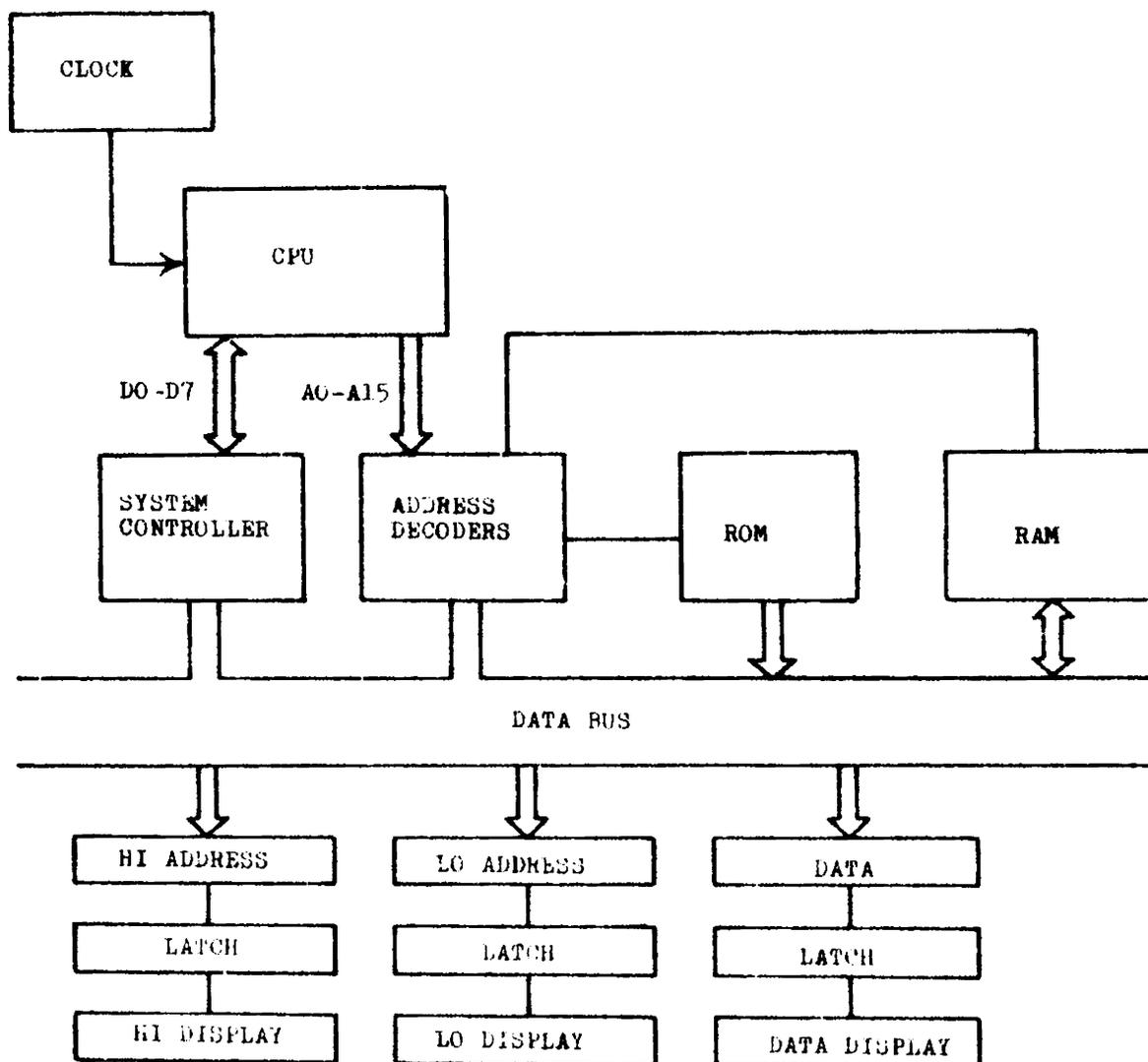
Fig. 5.1: BLOCK DIAGRAM OF THE SWITCHING SYSTEM
