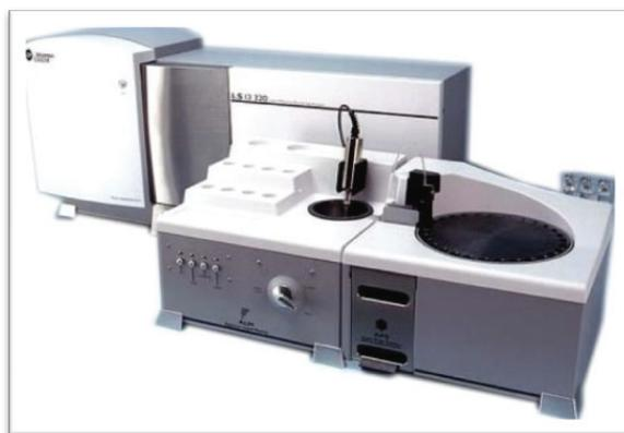
**Fig. 7.3** Particle size analyser
