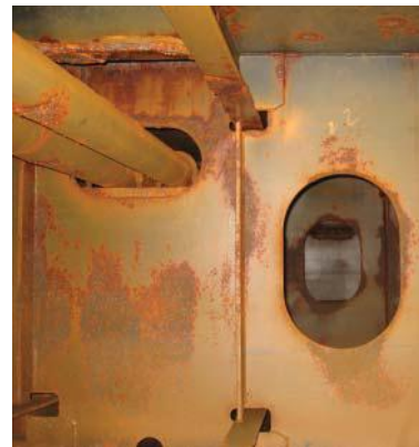
Fig 2.2 (d) General breakdown of coating 10% - 20%
